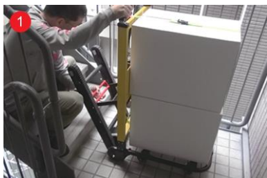
階段に合わせて走行ベルトの角度を調整
