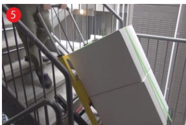
走行ベルト全体が階段に接触するまで傾斜
