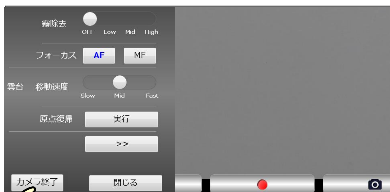
図 14-1 点検カメラコントロール メニュー画面
