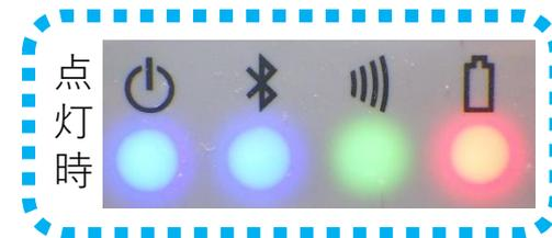
「Dragon\_BLE」ICカードリーダーの起動は、電源スイッチ(赤枠)を長押すると、LEDの①②③が一回点灯して起動音後に②だけ早点滅します。建レコアプリを起動して、認識させて下さい。
