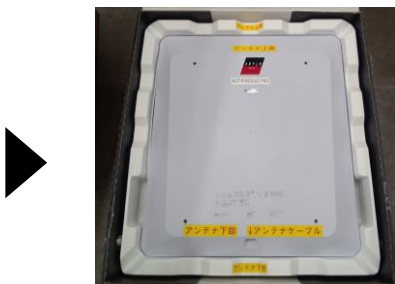
手順5. アンテナを収納します ※向き注意
