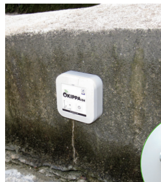
コンクリート部に設置 (アンカー利用)
