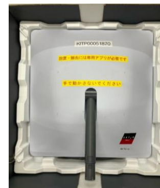
手順4. アンテナを収納します ※収納モードになっていること ※向き、支柱に注意
