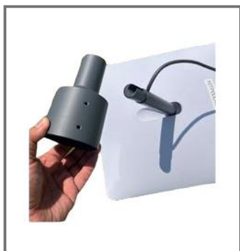
手順1. アンテナから単管マウントを外す
