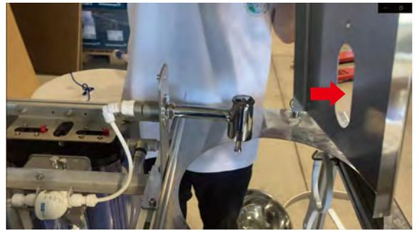
六角レンチ/アレンキー(5号)を使用し、右写真・赤枠二か所のネジを強く締める。(本締め)
