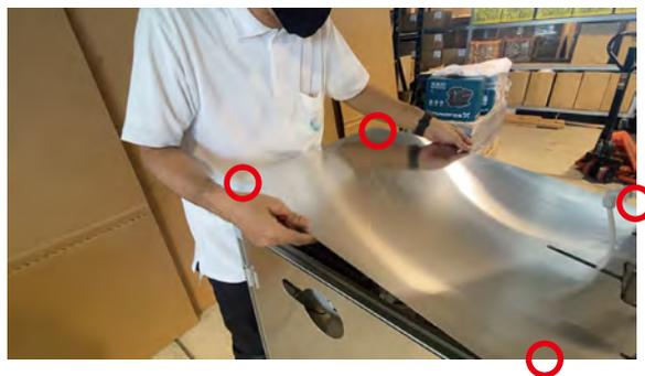
マイナスドライバーなどを、カバークリップの間に差込み、上に持ち上げてカバークリップをすべて取り外してください。
