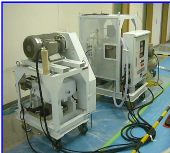
超高压ジェットミストポンプシステム
