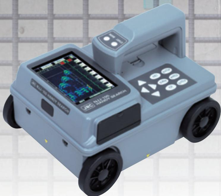
近年、コンクリート建造物では耐久性向上のため、密接鉄筋が多くなり、より分解能の高い探査機器が求められるようになりました。
