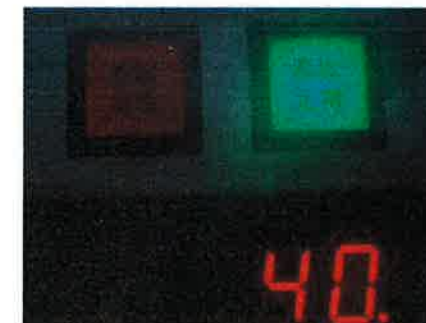
OUT2の出力時 温度正常点灯
