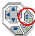
画像が表示されているときにメニューボタンを押し、一番下の角度の表示まで移動します。角度の表示画面でカメラマークを一度押すと水平に戻ります。アプリの場合は角度マークを一度タッチすれば水平になります。
