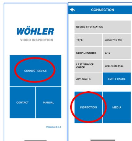
アプリを開き「CONNECT DEVICE」を押した後「INSPECTION」を押すとアプリ上でカメラ画像が映ります。カメラヘッドは携帯電話のディスプレイやタブレットから操作できます。動画や静止画を撮影した後、スマホで確認したい場合は保存ファイルフォルダに移動し撮影した画像を選択して「DOWNLOAD」を押してスマホ本体に保存してください。
