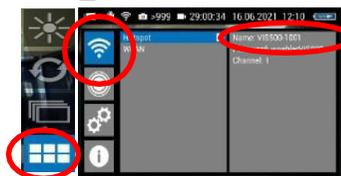
電源ボタンを一度押して一番下のメニュー表示でカメラマークを押します。一番上の電波アイコンでカメラマークを押します。
