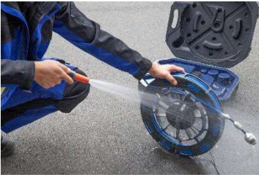
図57：ホイールとロッドを洗浄する
