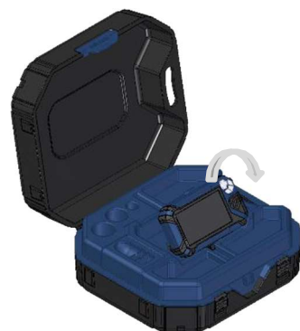
図10：モニターの上下の角度を調節する
