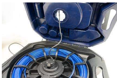
図60：誤った例：モニターケーブルが緩んでいる
