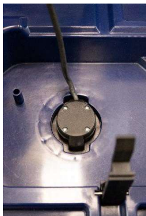
図59：モニターケーブルを上部シェルに通して慎重に引っ張る
