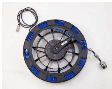
図56：モニタープラグに蓋をかぶせて ケースから取り外したホイール
