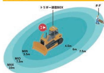
トリガー送信ボックスを中心に、360度全方位に磁界を出力します。ICタグを持った人が磁界に入ると、信号灯の音と点灯でお知らせします。
