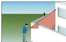
チルトセンサーと測距結果から、水平距離を算出します。詳細画面ではレーザー照射ポイントと水平ポイント間の高さが表示されます。
