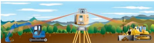
トプコンのレベルセンサーと共に使用することで、重機の施工高を管理できます。
