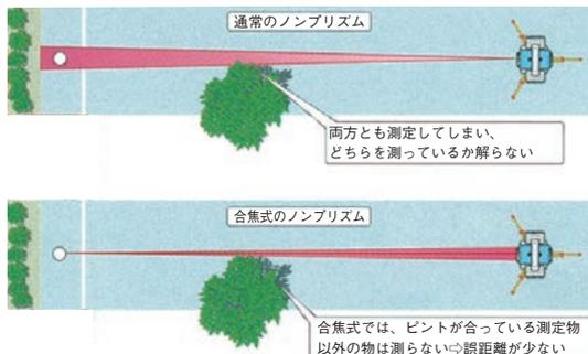
通常のトータルステーションではプリズムを使用しなければ測距・測角を行えませんがノンプリズム搭載型ならプリズムなしでも測距・測角が可能です。測距系に使用しているレーザーは安全基準クラス1のアイセーフティタイプの為、光学系に保護フィルタを組込む必要がなく、ノンプリズムタイプ以外の機器と変わらない望遠鏡の明るさを発揮します。
