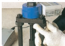
④床面の凹凸に合わせて脚の高さを調整する。
