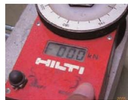
5. アダプターナットを軽く手で締めて、アンカーに0.3~0.5kNの予荷重をかけます。
