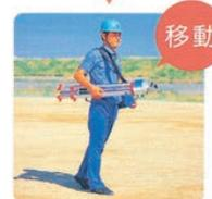
スウェーデン式貫入試験機は、1kN(約100kg)の錘の荷重と、回転によるロッドと土の貫入抵抗を測定し、その硬軟と地盤の縮りを判定する現位置試験です。この試験を行うことによりNswが求められ、そこからN値、qa(長期許容支持力)、qu(一軸圧縮強度)を換算して求めることができます。
