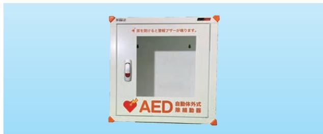
メーカー問わずお使い頂ける壁掛け収納ケースです。扉を開けるとブザーが鳴ります。寸法：W400×D180×H400mm(取付穴位置：W240×H250mm) 質量：約6.5kg
