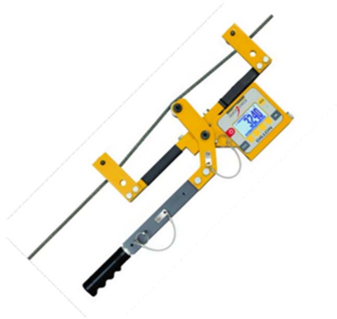
図 3.2 クイックチェックをケーブルに取り付けた状態
