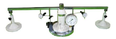
φ300mmの載荷板を油圧ジャッキにより載荷して、その沈下量をダイヤルゲージ2点で測定し、荷重量と 沈下量から構造物基礎の地耐力(支持力)を求めるのに使用します。
