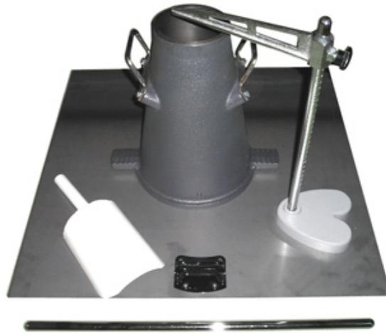
練ったコンクリートのコンシステンシーを測定する最も一般的な試験器具です。
