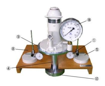
JIS A 1211 に規定されるとおりの油圧ジャッキを使用した現場 CBR 試験装置で、油圧ジャッキは 50kN のもので最小目盛 1kN のブルドン管式圧力計を使用しています。
