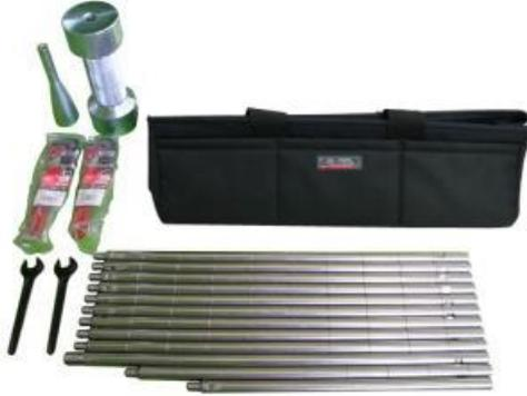
簡易動的コーン貫入試験は、質量 5 k g のハンマーを 50 c m の高さから自由落下させ原位置における土の貫入抵抗を簡易に求めることを目的としたものです。
