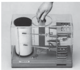
18 キャリングハンドルを正面にまっすぐ向けて、アクリルカバーはSK SATOのプレートが前にくるように取付ける。
