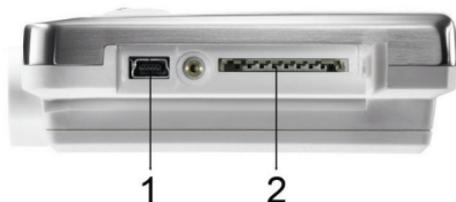
5. USB ケーブルを Mini USB ポート(1)に挿入します。
