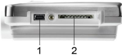
4. ミニ USB ポート(上図 1)に USB ケーブルを接続します。
