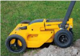
ヘッド部分が可動し、凹凸面でも安定した計測が可能。
