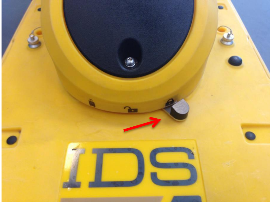
Fig. 4.4 – 2 輪バージョン用のアンテナ・ロッキング・レバー
