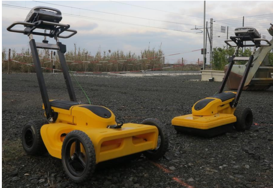
Fig. 3.9 – OPERA DUO の 2 及び 4 輪バージョン
