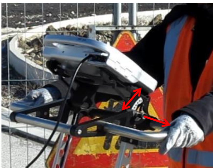
Fig. 4.3 – ラップトップ・サポート傾斜調節
