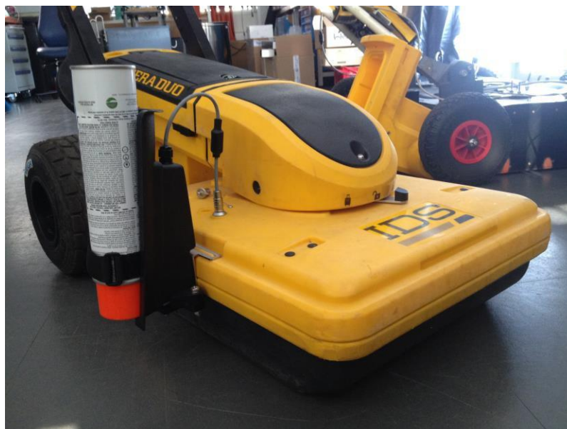
Fig. 4.11 – スプレー・サポート固定
