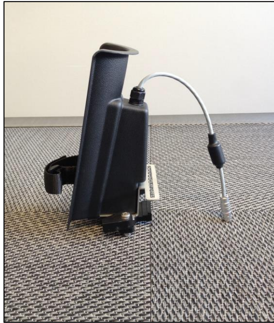
Fig. 4.10 – スプレー・サポートとケーブル
