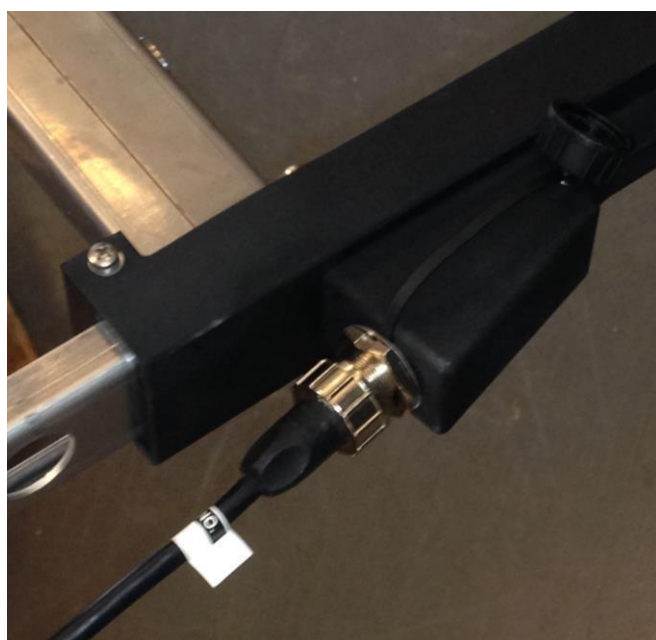
Fig. 3.8 – ハンドル上の ETHERNET ケーブル・プラグ
