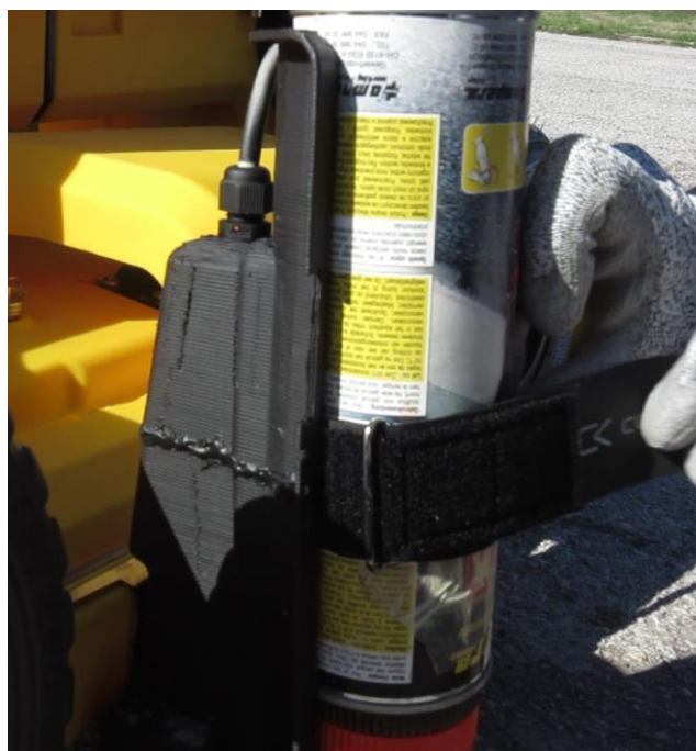
Fig. 4.15 – スプレー缶挿入
