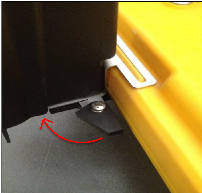
Fig. 4.12- ロックング・システム BEFORE
