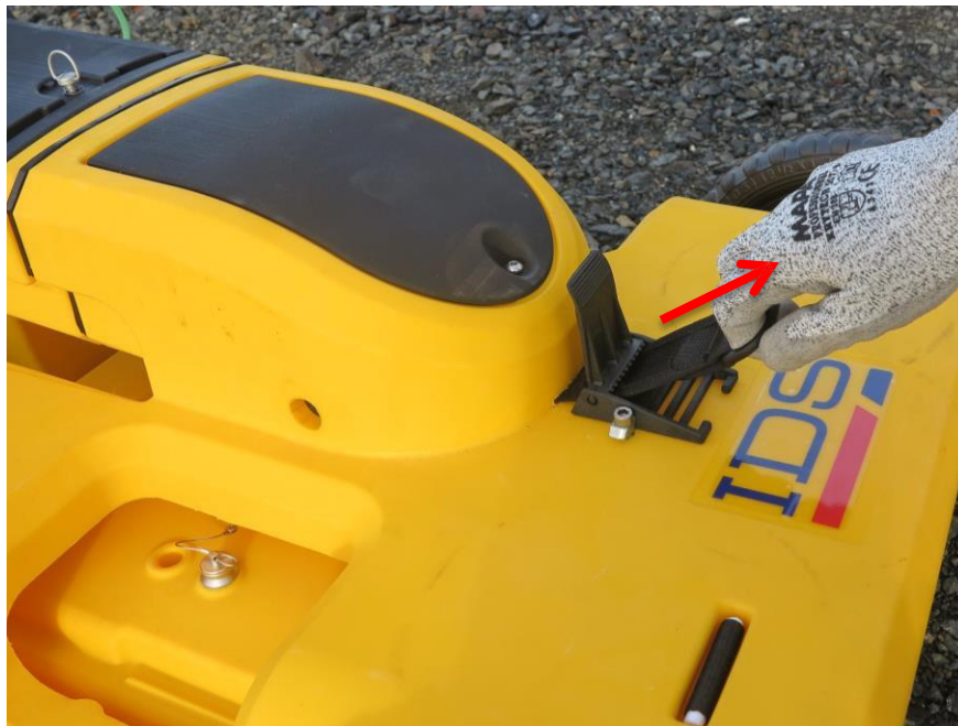
Fig. 4.5 – アンテナ高さ調節
