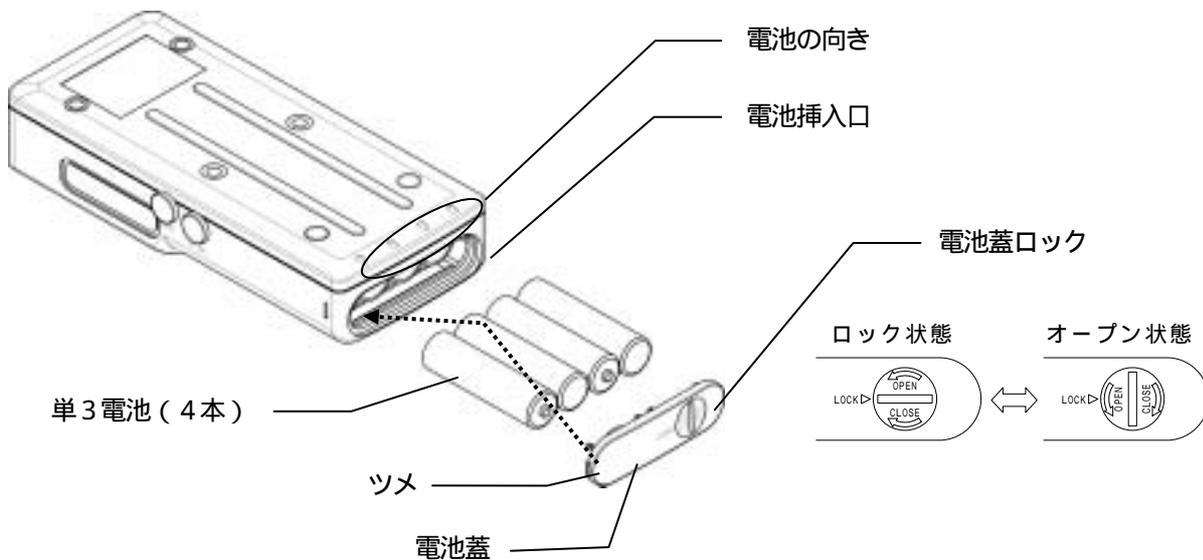
コインなどを用いて電池蓋のロックを反時計回りに回転させオープン状態にする。
