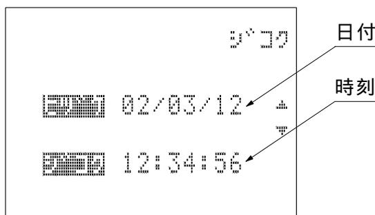
、キーで日付または時刻を選択して、テンキー及び<、>キーで日時を入力します。日時設定は、下図の例のように2桁で入力して下さい。
