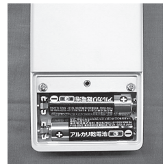
電池フタを外したところ
