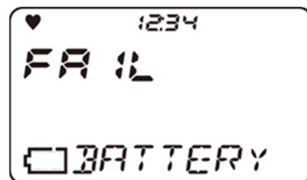
電池電圧異常
