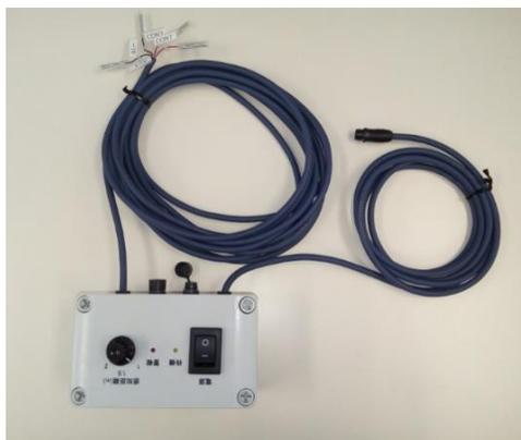
出荷時、検知開始終了制御端子2本(CONT)は制御ケーブル(0.2m)で接続されています。
