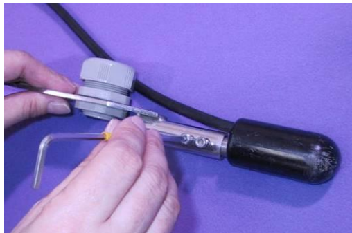
② 六角レンチを用いてセンサーと固定金具をボルトで固定します。
