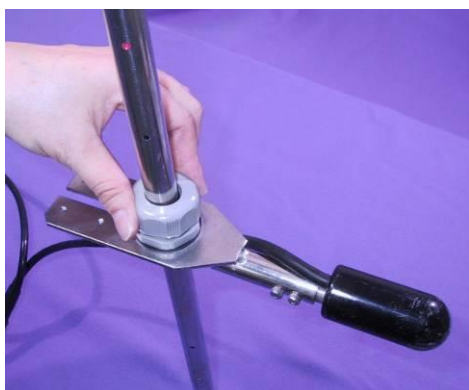
⑤ 任意の位置で固定金具のリングを回し、固定します。センサー方向指示金具も同様にビスで固定してください。
