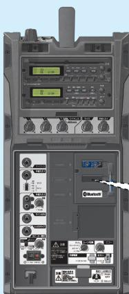
Bluetooth®ユニットBTU-100がワイヤレスチューナー部最下段に挿入されていることを確認してください。
