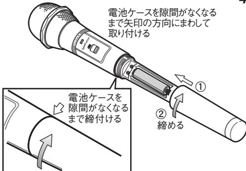
電池ケースを隙間がなくなるまで矢印の方向にまわして取り付ける
