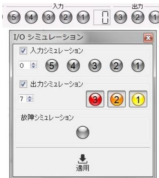
図 4.6-5 入力値0にして、I/Oシミュレーションした場合の入出力ランプの表示
