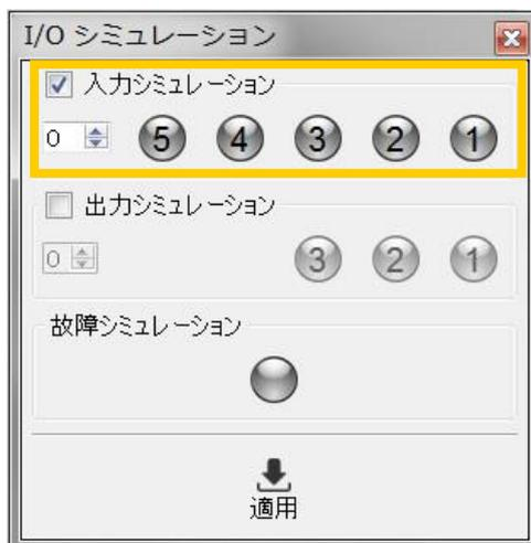
図 4.6-2 入力シミュレーションのチェックボックスを有効にしたときの表示
