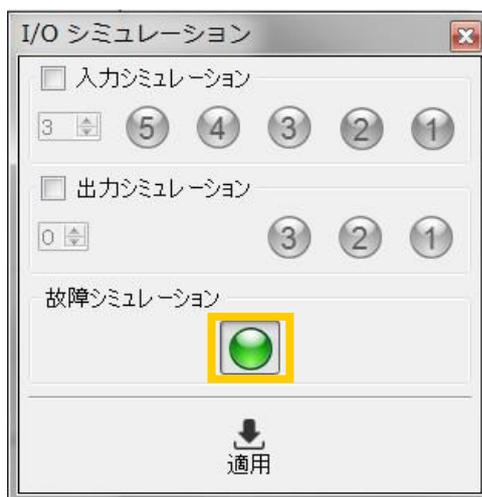
図 4.6-4 故障シミュレーションのランプを押した状態
