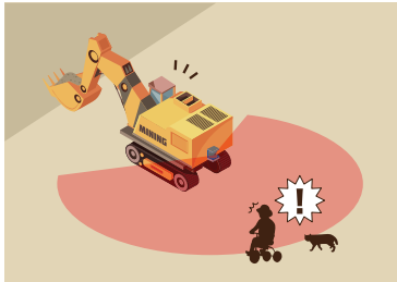
大型重機の後方の安全対策
