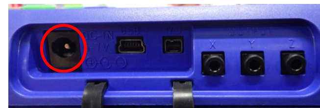
ACアダプタ接続部 (本体側面ゴムカバー内部)
