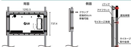
縦にも横にも設置が可能な55インチサイズのデジタルサイネージです。工事現場の仮囲い3枚分に設置し週間工程表、天気予報などを表示します。クラウド上※で画面編集が可能です。
