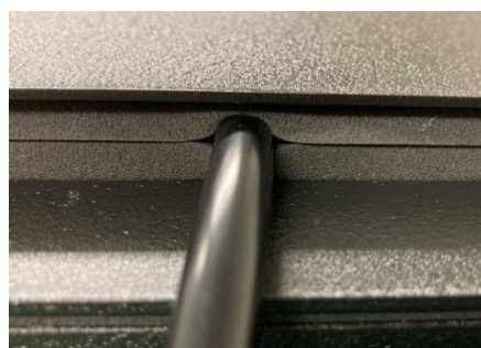
電源ケーブル引出し口
