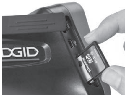
図9 - SDカードの挿入
