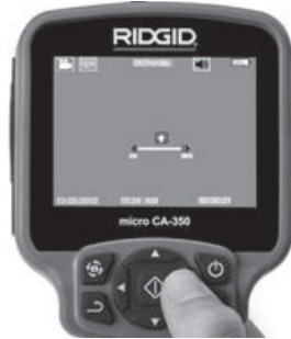
図 14 - LED の明るさ調整
