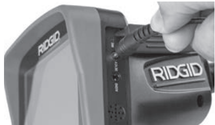
図6 - AC アダプターを使用した電源供給
