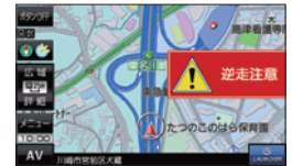
逆走検知警告
