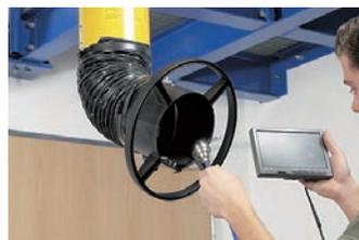
**カメラ部回転**…カメラ回転状況を表示。HomeFunctionで自動的にカメラ部を水平に復帰します。
