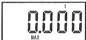
ピークホールド機能が動作しているときは、左図のように表示部に《MAX》マークが表示します。
