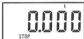
オートパワーオフ機能が動作しているときは、左図のように表示部に《STOP》マークが表示します。
