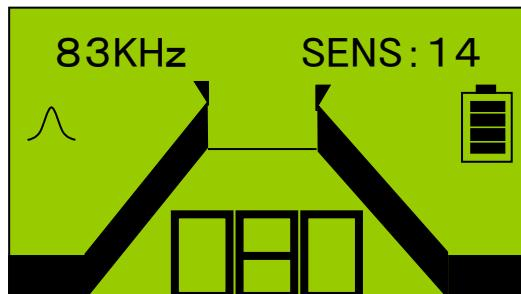
必要に応じて を押して感度調整をしながら、予想される管路を横断するように受信器を動かします。
