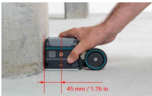
写真②-壁際 45mm まで探査可能
