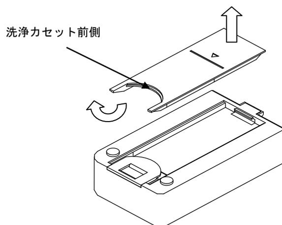
(3) 洗淨カセットを収納するときは、まず洗淨カセットの後ろ部分を電池ケースにはめ込み、次に洗淨カセットの前側を洗淨カセットストッパーに向けて押し込みます。最後に洗淨カセットストッパーを元の位置に戻してください。
