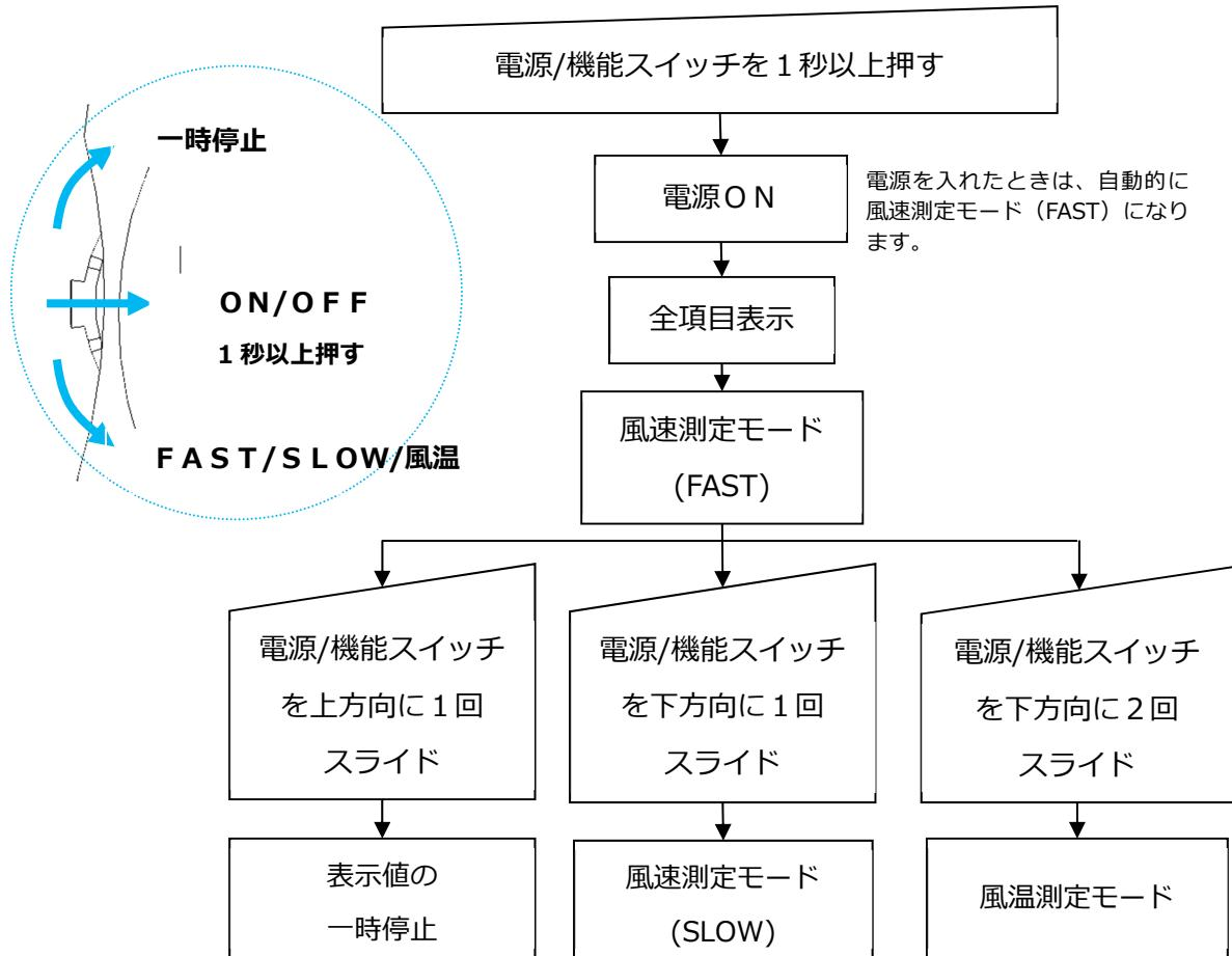
※ 時定数とは、測定値の応答性能を表す数値で、時定数を大きく設定すると値の変動が少ない測定値が読みとれます。逆に時定数を小さく設定すると、測定値が風速の変動に素早く反応します。
