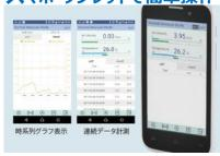
計測ソフトウェアでは、通常の計測値表示に加えて、グラフ表示や連続のデータ取り込み、CSV保存を行うことができます。風速・温度個別に上下限値を設定することで、画面上にアラート表示も行えます。
