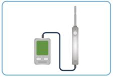
例えば製薬工場や病院など、無線の電波 使用に制限のある場所では、一般的な風 速計と同様にケーブルを用いた計測が可能
