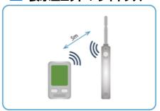
無線通信の届く範囲(5m)なら、高い場所 などプローブを離しての計測が可能です。 計測者と記録者がプローブと表示ユニットを 各々持って計測するといった使い方もできます。 ダクト点検口にプローブを挿入する際、ケーブ ルを引っかけて破損する心配もありません。
